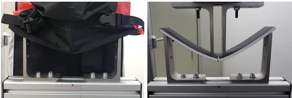
Abbildung 6: Darstellung Maximal-Verformung der Bodens (45 mm Durchbiegung); mit und ohne (nachgestellt) Tasche
